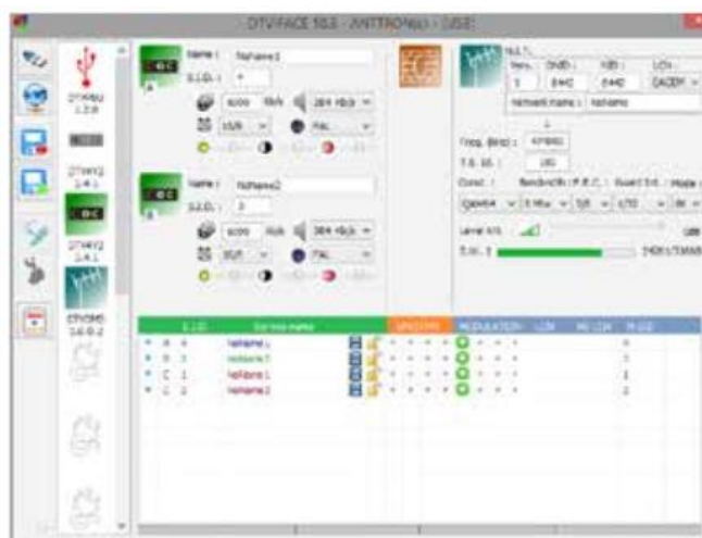
Rys. Program przeznaczony do programowania modulatora typu TM 300 i TM 400.
